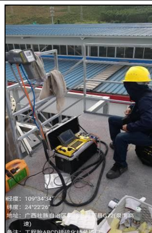
工程胎车间硫化线废气采样
